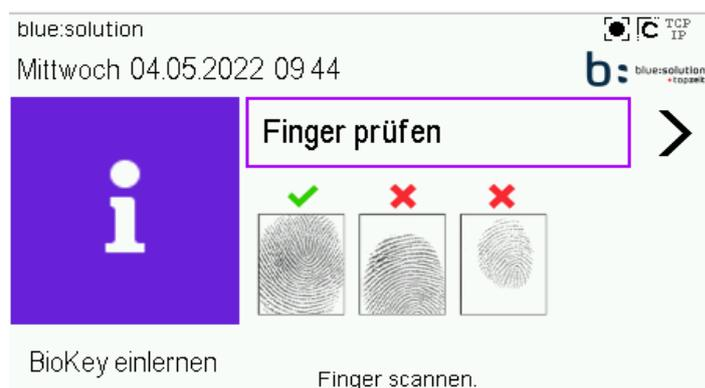
Um mit dem Einlernen fortzufahren, bestätigen Sie mit „>“. Sie werden nun aufgefordert einen Finger auszuwählen. Wählen Sie den Finger aus und bestätigen Sie anschließend mit der **Enter-Taste** bzw. mit „✓“ bei einem EVO 4.3 mit blue:solution Design.
